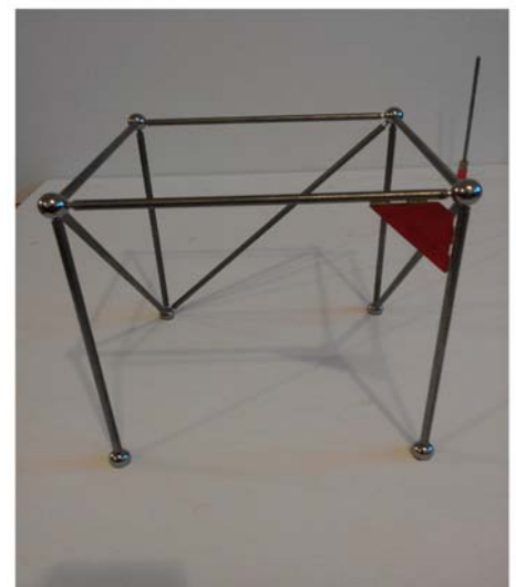
Kinematische Bestimmtheit durch biegesteife Ecke (vorne) und Stäben (restliches System)
