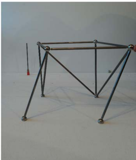
Kinematisch unbestimmtes System (bewegliches Teilsystem in der vorderen Ebene)
