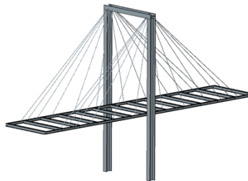
Entwurf einer Schrägseilbrücke mit mittigem Pylon
