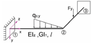
Ebenes System mit Belastung senkrecht zur Ebene
