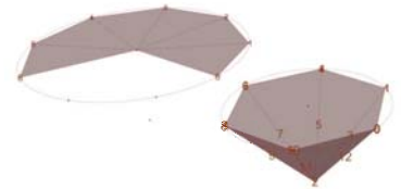
Virtuelles 3D-Faltmodell einer 6-flächigen Pyramide in Rhinoceros
