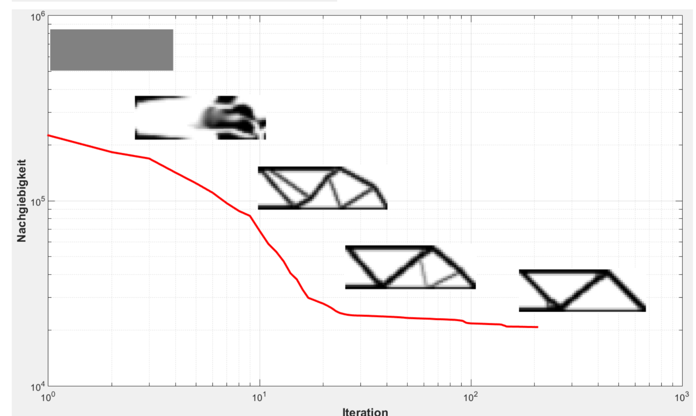
Ein Iterationsverfahren der Topologieoptimierung durch SQP-Algorithmus
