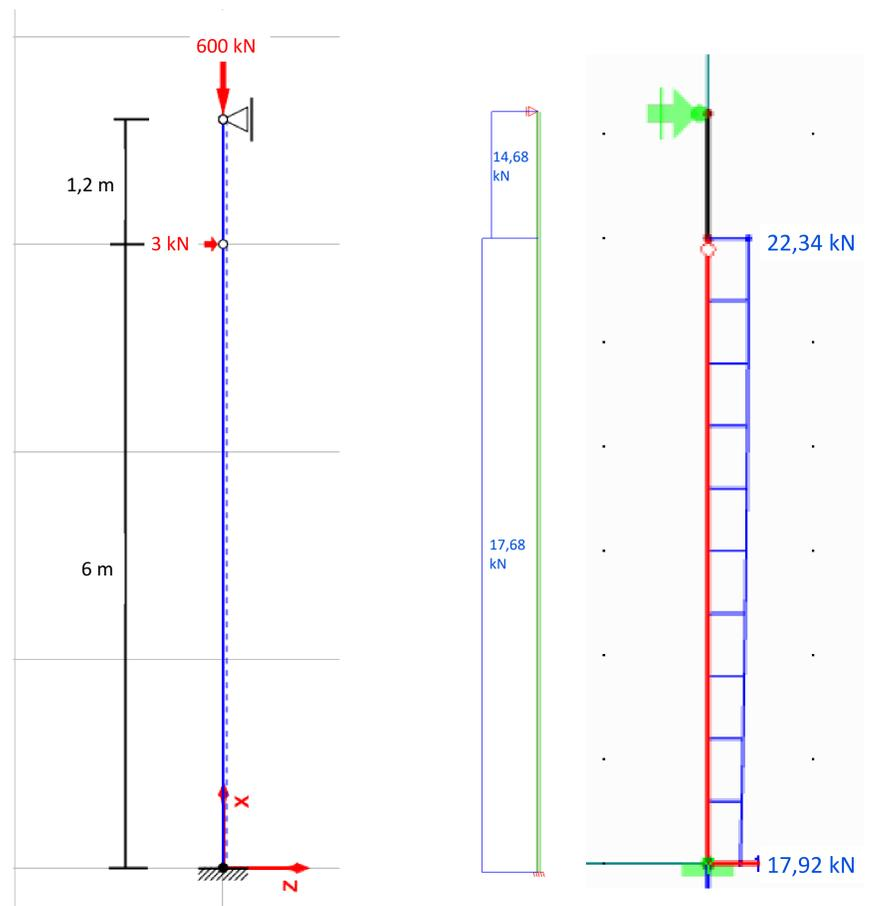
Links: Modellstruktur „Kragstütze mit kurzer, aufgesetzter Koppelstütze“
