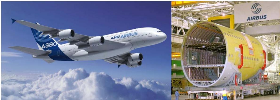
**Abbildung 1.1:** Schalenstrukturen im Flugzeugbau: Airbus A380 (AIRBUS (2013a), AIRBUS (2013b)).
