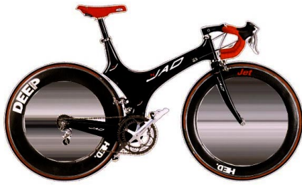
Rennrad: Carbonfaser-Rahmen Quelle: JAD (2002)
