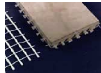
Bild 1.3: Bauteile aus Textilbeton, dünnwandige Konstruktionen, Basismaterialien
