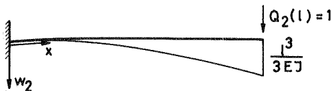
Bild 6: Kragträger mit Belastung durch die stat. überzählige Querkraft Q_2(l) = 1
