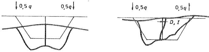
a) Symmetrische und antimetrische Profilverformung
