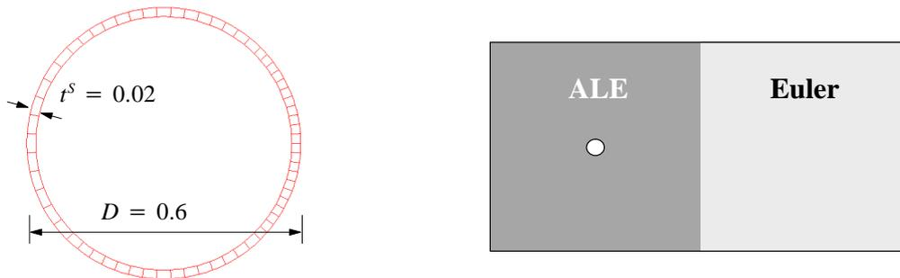
Bild 7.18: Diskretisierung des Zylinders und Aufteilung des Strömungsgebietes
