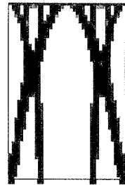
Bild 4.14: Einfluß der Spannungsnebenbedingungen auf die optimale Topologie bei verschiedenen Auflagerbedingungen
